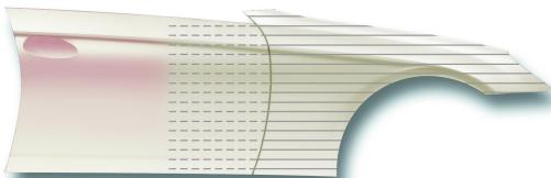
Fjern afdækningen og sprøjt ud med bundfarven på de tilstødende paneler. 5 - 10 minutter slutafluftning efterfulgt af 15-20 minutter ved 60-65°C emnetemperatur. Lad overflader afkøle til normal temperatur.
