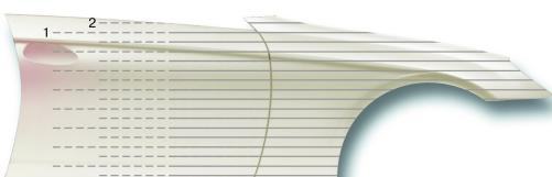
Påfør Standohyd Plus Basecoat effekt farve til den fuldstændige nye del og udjævn til de tilstødende dele. Sprøjt det første lag til det yderste område, hvis nødvendig påfør 2. og 3. lag med mellemafluftning. Arbejde tilbage fra det bredeste område med forskudte overlappende effekt lag for at undgå en stærk hologram / synlig kant og giver en glat overgang. Start fra bredeste område og arbejde hen imod midten.
