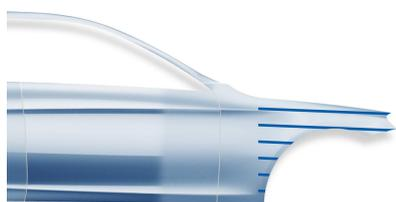
Påfør Standoblue Basecoat til de resterende reparerede områder (fylder) med normal 1,5 lags proces. Sprøjtetryk 1,5-2,0 bar.
