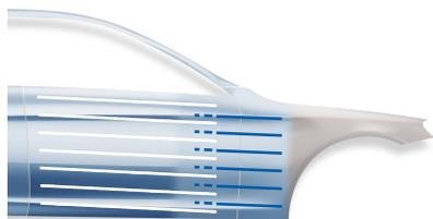
Påfør 1 lag Standoblue basefarve op til kanten af Standoblue Color Blend og forsæt ind i de tilstødende område/dele. Forsæt med at sprøjte et effekt lag ud i den våde Standoblue Color Blend.
